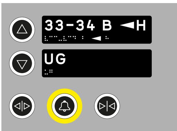
Abbildung 6: Lift Tableau mit Richtung Taster.
